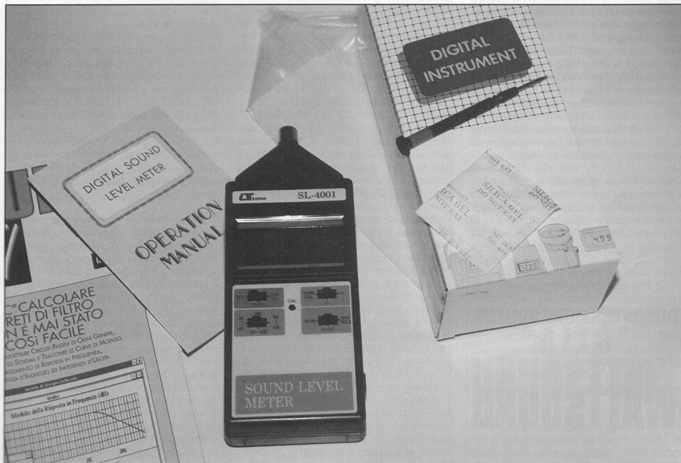
Fig. 1 - Aspetto esterno dello strumento: si notino il grande display LCD ed i quattro commutatori a slitta per il controllo delle varie funzioni.
