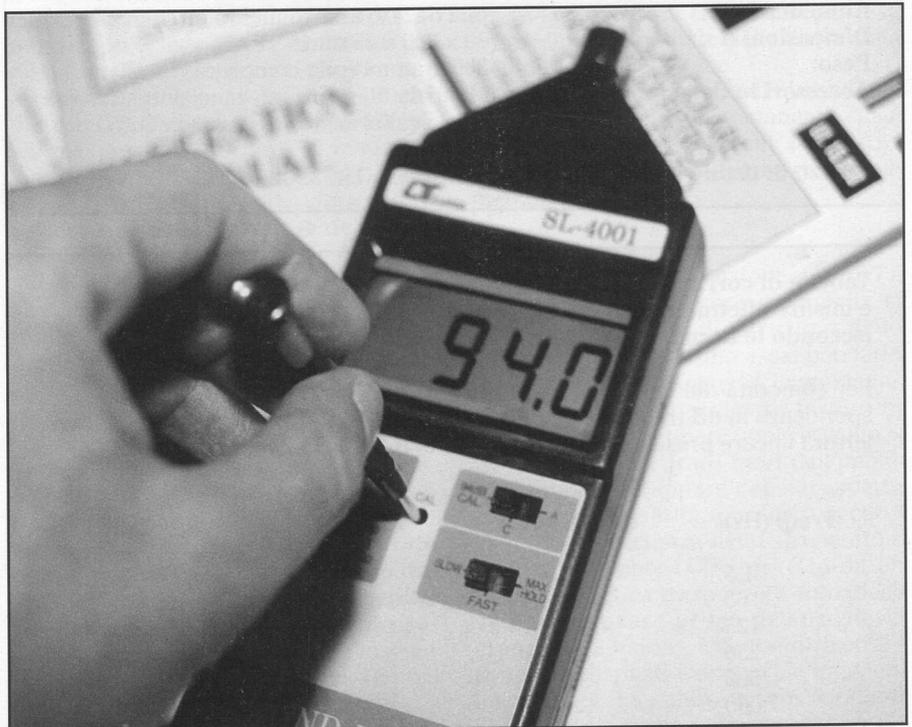
Fig. 4 - L'operazione di calibrazione dello strumento viene effettuata ruotando l'apposito trimmer con il cacciavite in dotazione (dopo aver disposto opportunamente i vari selettori), sino ad ottenere sul display l'indicazione 94.0 dB.
