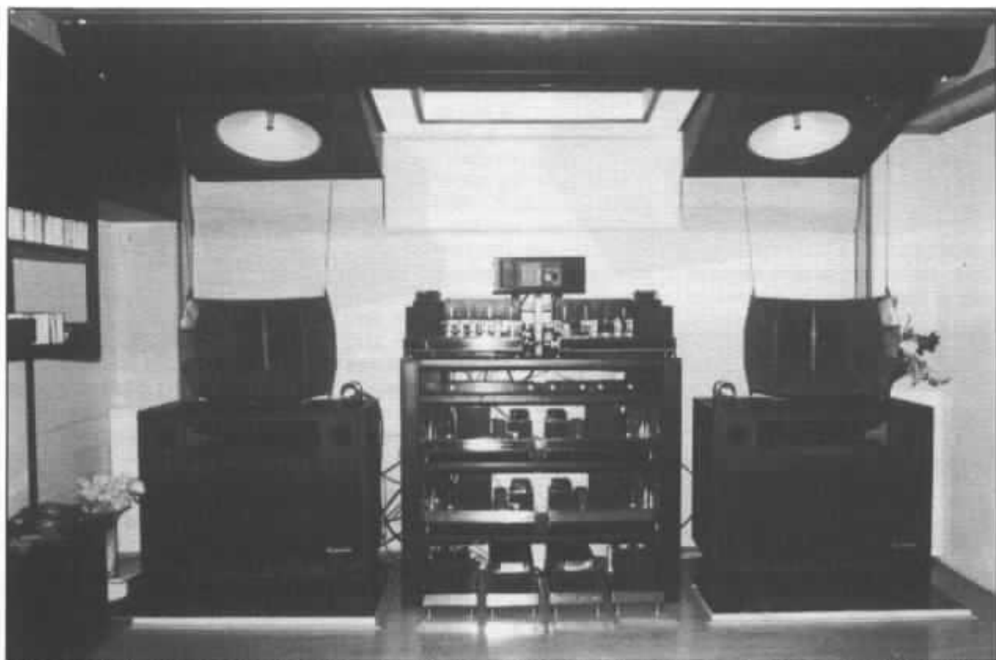
Vue partielle du système de M. Chien. Enceintes Westlake SM-1F : 2x38 cm Gauss + 2 moteurs JBL 375 (médium) et LE85 (aigu), pavillons Vitavox, tweeters Coral, enceintes Hartley au plafond, amplification Jadis, filtres actifs Westlake. A noter le traitement acoustique des murs et du plafond.
