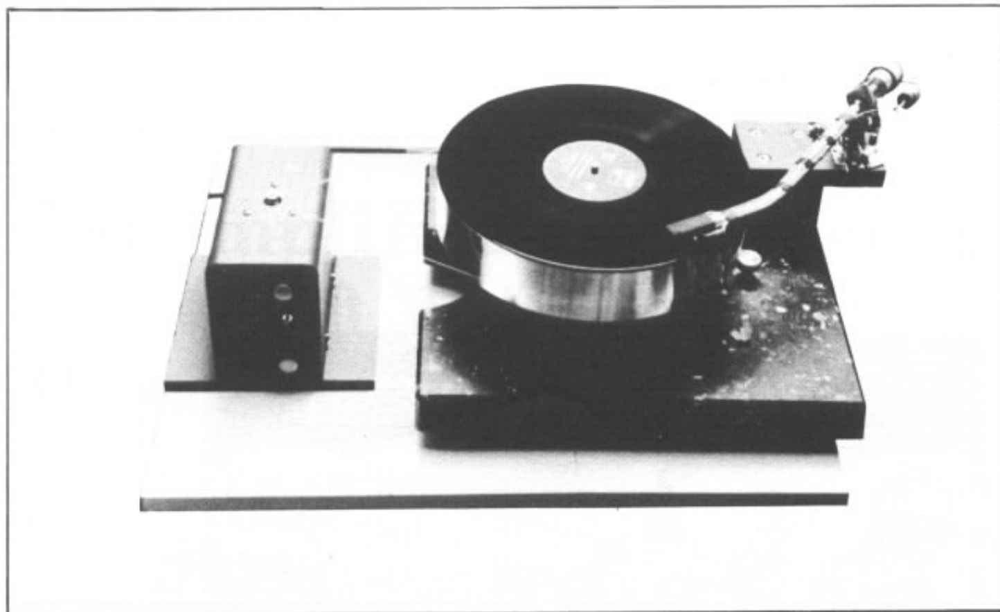
Fig. 5 : La platine Verdier version 87 avec son nouveau bloc moteur. L'entraînement par fil offre de nombreux avantages par rapport à la courroie. La courroie, de par son élasticité, est le siège de propagation de vibrations longitudinales provoquant un entraînement par à-coups (phénomène de traction-extension), en outre sa fabrication est extrêmement délicate pour offrir une fluctuation inférieure à 0,2 %. En outre, le glissement du fil sur la périphérie du plateau qui pourrait être considéré comme un défaut est en fait un point fort car il participe à « lisser » l'entraînement.
