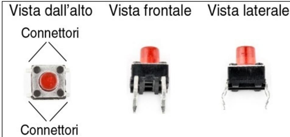
Il pulsante presenta quattro connettori che si possono inserire senza fatica su una breadboard (al massimo dovete sforzare i connettori utilizzando delicatamente ma in modo deciso un paio di pinzette da orologiaio). Due terminali opposti sono collegati elettricamente tra loro quando premete il pulsante, altrimenti la connessione è aperta.
