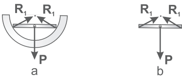
Fig. 2.5. Un'asta vincolata da un recipiente, soggetta alla forza peso P e alle reazioni vincolari R_1 e R_2 (a), e suo diagramma di corpo libero (b)
