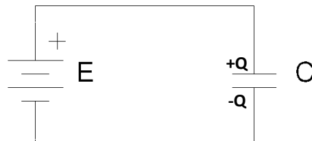
Figura 6.15. Condensatore collegato a un generatore di tensione
