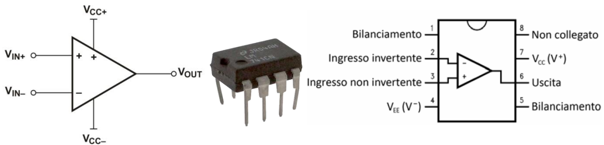
Figura 18.4. Simbolo circuitale di un OPAMP: morsetti di ingresso ( V_{IN} ), di alimentazione ( V_{CC} ) e di uscita ( V_{OUT} ); DIP package di un OPAMP e pedinatura
