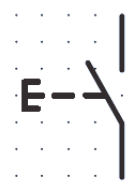
Figura 24.26. Simbolo circuitale Contatto di chiusura con comando a pulsante a ritorno automatico
