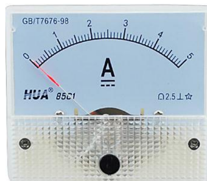
Figura 2.2. Amperometro analogico, di classe pari a 2,5
