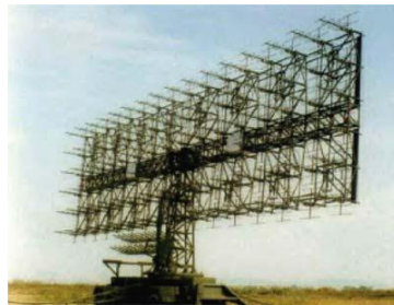
Figura 23.26. Array di antenne
