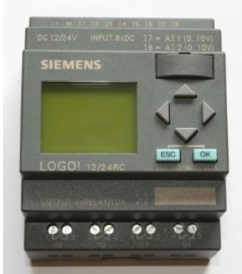
Figura 34.1. Un PLC della Siemens
