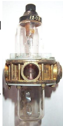
Figura 23.4. Celle TR CV43 e ATR CV115
