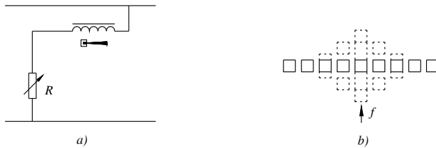
Fig. IX.12.7 a) Schema indicativo di un frequenzimetro a risonanza meccanica; b) lamelle vibranti.
