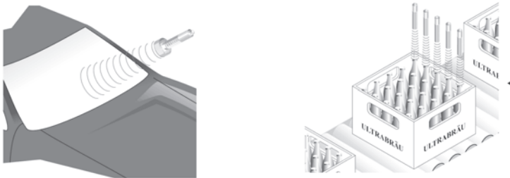
Fig. XIII.3.16 Alcuni esempi di utilizzo dei sensori di prossimità ad ultrasuoni.
