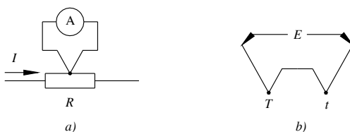
Fig. IX.3.7 Schema di principio di uno strumento a termocoppia: a) a giunzione semplice; b) a doppia giunzione.
