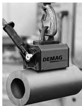
Fig. 3.99 - a) Esempi di magneti permanenti - b) Esempio di utilizzo di un magnete permanente nel mezzo di presa in un sistema di sollevamento con portate da 150 kg a 2000 kg, adatti sia per materiali ferrosi a sezione circolare sia di tipo piatto. Da notare che un mezzo di presa di questo tipo è utilizzabile ovunque e risulta indipendente da qualsiasi alimentazione elettrica al contrario degli elettromagneti.
