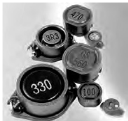
Fig. 3.148 - Principali caratteristiche degli induttori con nucleo ferromagnetico schermato.
