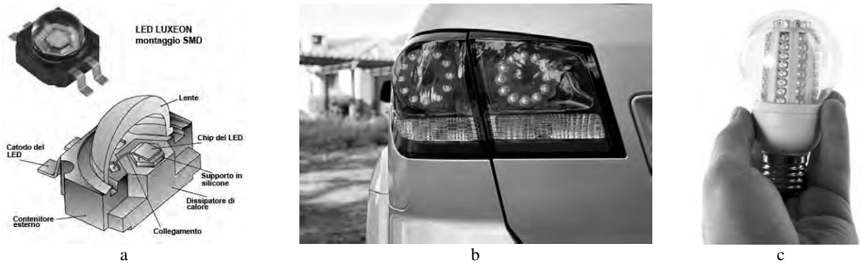
Fig. 3.172 - Esempi di applicazione dei diodi LED: a) Struttura interna di un diodo LED ad alta luminosità a montaggio superficiale SMD - b) Luci LED posteriori di posizione e di arresto per automobili - c) Lampada a LED a basso consumo per l'illuminazione di ambienti.
