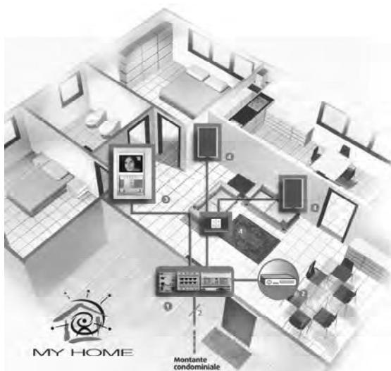
Fig. 6.44 - Esempio di integrazione ad un impianto videocitofonico a 2 fili: la diffusione sonora.
