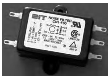
Fig. 3.150 - a) Filtro di rete monofase. Da notare lo schema elettrico riportato sul contenitore dove è possibile riconoscere gli induttori e i condensatori utilizzati dal filtro - b) Circuito stampato e relativi componenti di un filtro di rete monofase - c) Esempi di prese con incorporato il filtro di rete. In alcuni tipi è presente l'interruttore e/o un fusibile di protezione dai cortocircuiti.
