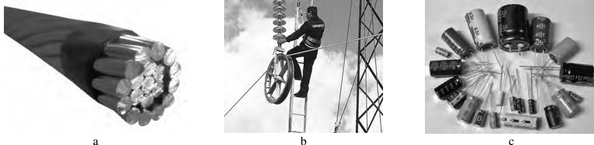
Fig. 3.52 - a) Conduttore alluminio-acciaio - b) Fase di montaggio di un conduttore alluminio-acciaio in un elettrodotto - c) Condensatori che utilizzano come dielettrico (isolante) l'ossido che si forma sul metallo.
