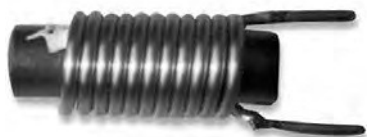
Fig. 3.147 - Principali caratteristiche degli induttori con nucleo ferromagnetico non schermato.
