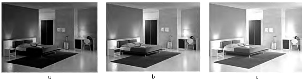
Fig. 5.98 - Esempio di ambiente illuminato con lampade aventi una diversa temperatura di colore: a) Luce calda - b) Luce con tonalità intermedia - c) Luce fredda.
