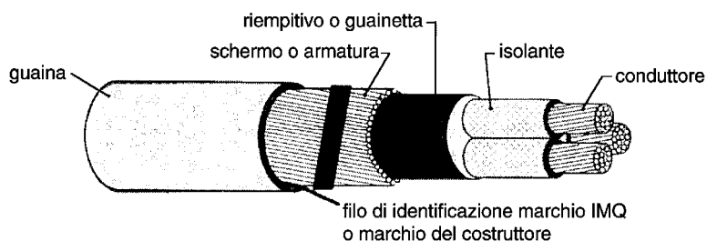
Fig. 4.18 - Parti costituenti un cavo (non sempre sono tutte presenti contemporaneamente).
