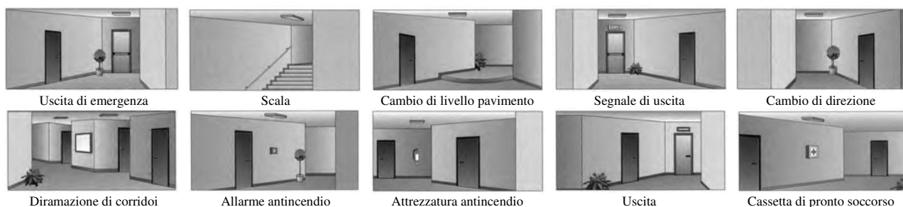
Fig. 4.169 - Esempi di applicazione delle apparecchiature di illuminazione di emergenza e segnaletica.
