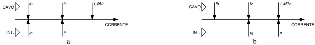
Fig. 4.47 - Condizioni limite di una condotta contro il sovraccarico: a) Massima protezione - b) Minima protezione.
