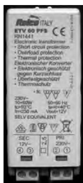
Fig. 4.145 - Trasformatore elettronico per lampade alogene a bassissima tensione: - a) Esempio di caratteristiche tecniche - b) Scheda elettronica. Da notare, sulla sinistra i morsetti di alimentazione a 230 V, mentre sulla destra i morsetti di uscita a 12 V da collegare alle lampade alogene a bassissima tensione, nonché il trasformatore, realizzato con nucleo di ferrite, che consente di ottenere un’alimentazione di sicurezza di tipo SELV (Relco).
