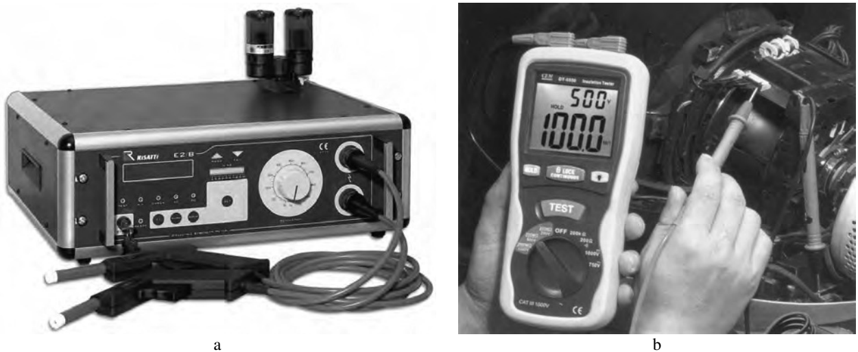
Fig. 3.69 - a) Misuratore digitale della rigidità dielettrica con puntali retrattili di sicurezza; la tensione applicata è regolabile mediante un potenziometro posto sul pannello frontale - b) Esempio di applicazione di un misuratore della resistenza di isolamento digitale; sul display compare il valore della tensione di prova (500 V) e il valore della resistenza di isolamento (100,0 MΩ).
