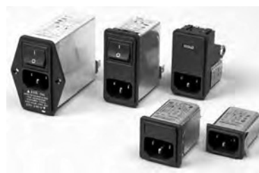
Fig. 3.150 - a) Filtro di rete monofase. Da notare lo schema elettrico riportato sul contenitore dove è possibile riconoscere gli induttori e i condensatori utilizzati dal filtro - b) Circuito stampato e relativi componenti di un filtro di rete monofase - c) Esempi di prese con incorporato il filtro di rete. In alcuni tipi è presente l'interruttore e/o un fusibile di protezione dai cortocircuiti.
