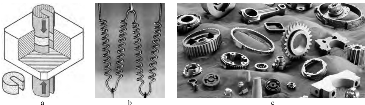
Fig. 3.97 - a) Esempio di pressa per la agglomerazione delle polveri - b) Esempio di filamento per lampade ad incandescenza in tungsteno realizzato per sinterizzazione - c) Esempi di pezzi meccanici realizzati per sinterizzazione.
