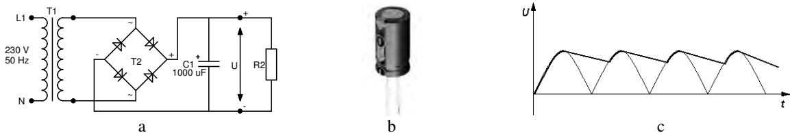
Fig. 3.167 - Esempi di applicazione dei diodi raddrizzatori: a) Alimentatore con trasformatore T1 , raddrizzatore monofase ad onda intera con ponte di Graetz ( T2 ) e condensatore di livellamento C1 - b) Condensatore elettrolitico di livellamento C1 - c) Tensione livellata sul carico resistivo R2 .
