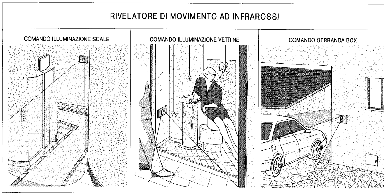
Fig. 4.185 - Esempi di applicazione dei rivelatori di movimento a raggi infrarossi (Gewiss).
