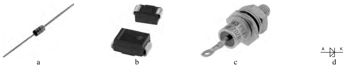
Fig. 3.168 - a) Diodo Zener di piccola potenza da 250 mW a 600 mW (si noti la fascetta che indica il catodo) - b) Diodi Zener del tipo a montaggio superficiale SMD - c) Diodo Zener di potenza da 3 W a 75 W con contenitore metallico con attacco filettato che può essere fissato ad un dissipatore. Disponibili in due versioni con anodo o catodo a massa - D) Segno grafico secondo le norme CEI.
