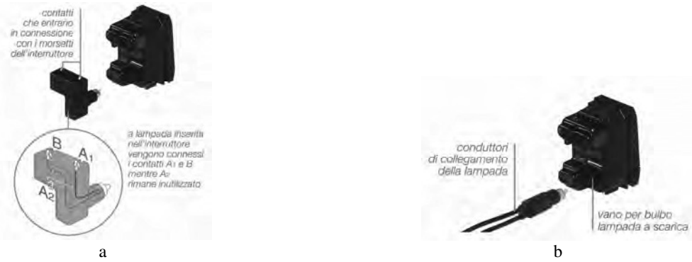
Fig. 6.6 - a) Lampada spia precablate impiegabile solo per la localizzazione - b) Lampada spia a collegamento libero (bticino).
