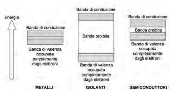
Fig. 3.6 - Bande energetiche nei metalli, negli isolanti e nei semiconduttori.
