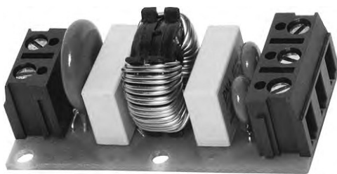
Fig. 3.150 - a) Filtro di rete monofase. Da notare lo schema elettrico riportato sul contenitore dove è possibile riconoscere gli induttori e i condensatori utilizzati dal filtro - b) Circuito stampato e relativi componenti di un filtro di rete monofase - c) Esempi di prese con incorporato il filtro di rete. In alcuni tipi è presente l'interruttore e/o un fusibile di protezione dai cortocircuiti.
