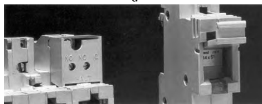
Fig. 4.103 - a) Portafusibile sezionabile per fusibili cilindrici - b) Modelli per fusibili 10x38, 14x51, 22x58 - c) Versioni disponibili, 1P, 1P+N, 2P, 3P+N, 4P - d) Tipi di fissaggio: a vite, per guida simmetrica, per guida asimmetrica - e) Funzioni complementari: microcontatto (NO+NC), segnalatore di fusione (Legrand).
