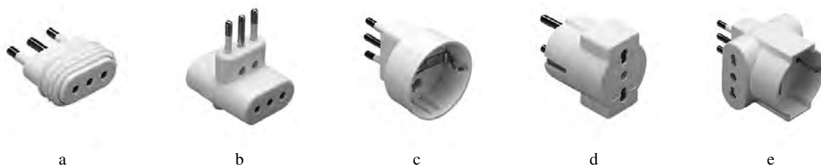
Fig. 4.115 - Esempi di adattatori (250 V AC, max. 1500 W): a) Adattatore semplice con una uscita da 10 A con schermi di sicurezza - b) Adattatore multiplo con due uscite laterali con schermi di sicurezza, 10 A - c) Adattatori semplici con una uscita 16 A UNEL con terra laterale e centrale 10 A - d) Adattatore semplice spina UNEL con una uscita 16 A bivalente - e) Adattatore multiplo con due uscite bivalenti e una uscita UNEL bivalente con terra laterale e centrale (Gewiss).
