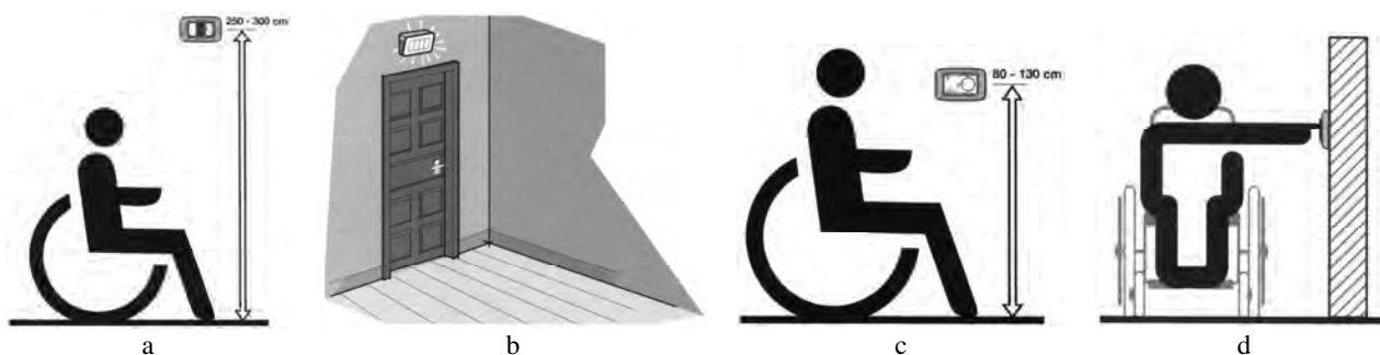
Fig. 7.106 - a) Altezza di installazione degli apparecchi di segnalazione - b) Cornice rialzata per scatola da incasso rettangolare - c) Altezza di installazione degli apparecchi di regolazione - d) Posizione di installazione degli apparecchi di regolazione.
