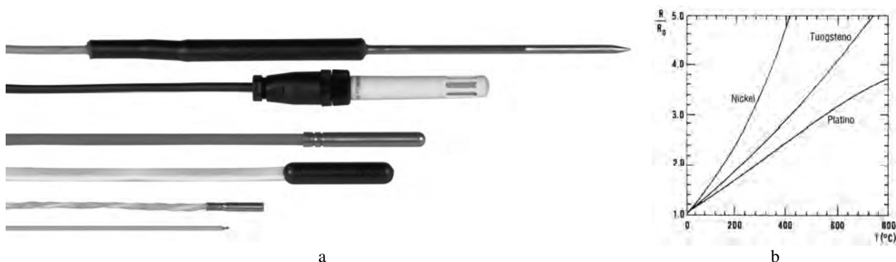
Fig. 3.116 - a) Esempi di termoresistenze. A destra l'elemento sensibile alla temperatura e a sinistra il cavo di collegamento - b) Andamento del rapporto R/R_0 tra la resistenza a una certa temperatura e quella nominale a 0^\circ\text{C} .
