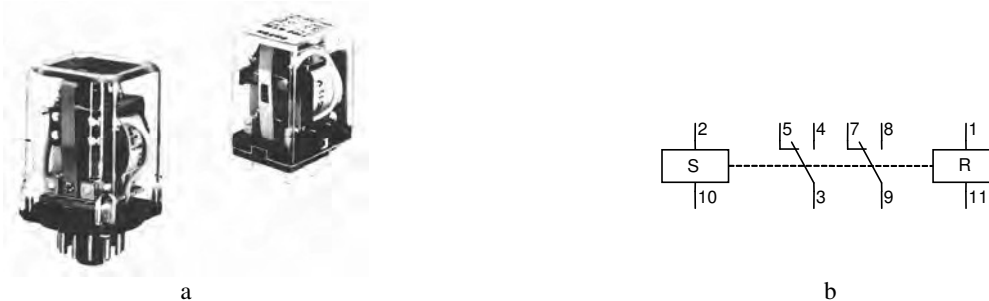
Fig. 4.123 - Esempio di relè bistabile tipo MK2K e MYK: a) Modelli disponibili - b) Collegamenti. Questi relè, del tipo a ritenuta magnetica o meccanica, sono disponibili con i terminali ad innesto e per circuito stampato (MYK), con 2 contatti in deviazione e con indicatore meccanico di stato. Sono disponibili modelli con bobina funzionante in AC (6÷230 V) o DC (6÷110 V). La corrente massima di passaggio è di 5 A, mentre la tensione massima di funzionamento è di 440 V AC e 250 V DC (Omron).
