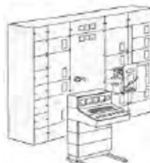
Fig. 4.9 - Esempio di impianto industriale in sbarre prefabbricate. Ambienti tipici: capannoni industriali per lavorazioni caratterizzate da elevati assorbimenti di corrente e da macchine di media e grande potenza unitaria. Per l'impianto di illuminazione bisogna predisporre condutture di altro tipo o sistemi di sbarre a bassa portata.
