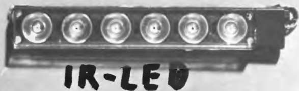
Foto 1. Una fila di diodi emittenti infrarossi, incorporata nel lato stretto della scatola nella quale è montato il trasmettitore. C'è spazio per due file affiancate.
