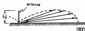
Fig. 163 - Diagramma d'irradiazione di un quarto d'onda verticale.
