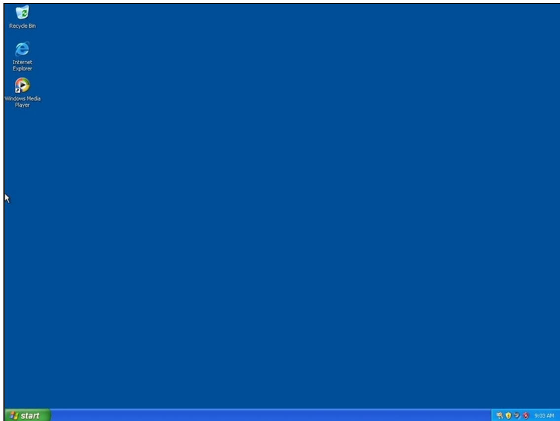
Figura 9.2 Questa macchina virtuale, basata su VirtualBox, è stata creata con una copia di Windows XP. La product key, cioè il codice di attivazione, non è obbligatoria, ma senza la copia di Windows funzionerà solo per 30 giorni.
