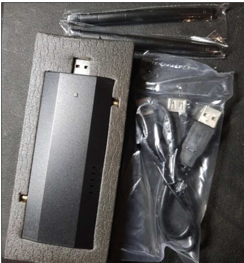
Figura 13.1 Il contenuto della confezione del WiFi Pineapple Nano. Questo modello non richiede alimentatore esterno, ma di essere collegato a due prese USB (da qui il cavo a Y fornito in dotazione).
