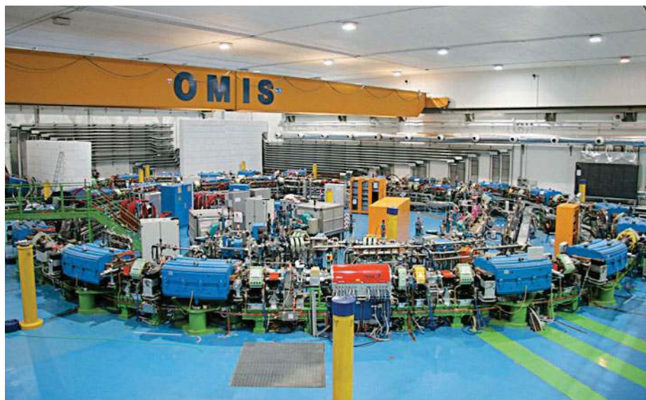
Figura 7 Il sincrotrone del Centro Nazionale di Adroterapia Oncologica di Pavia, progettato dalla fondazione TERA e costruito dalla fondazione CNAO e dall'INFN, è utilizzato per trattare tumori solidi profondi, anche radioresistenti, con fasci di protoni e di ioni carbonio.
