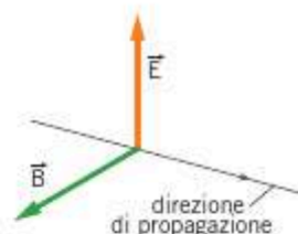
Figura 13 In un'onda elettromagnetica piana il campo elettrico e quello magnetico sono perpendicolari tra loro e alla direzione di propagazione dell'onda.
