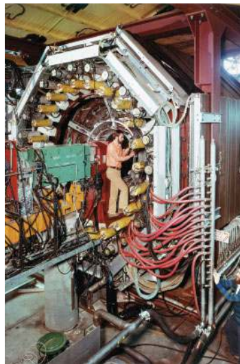
Figura 14 La scoperta del tauone fu fatta nel 1975 da Martin Perl e collaboratori, utilizzando il rivelatore MARK I montato sull'anello elettrone-positone SPEAR dello SLAC. I tauoni erano creati nelle annichilazioni elettrone-positone che avvenivano al centro del rivelatore, di forma esagonale.
