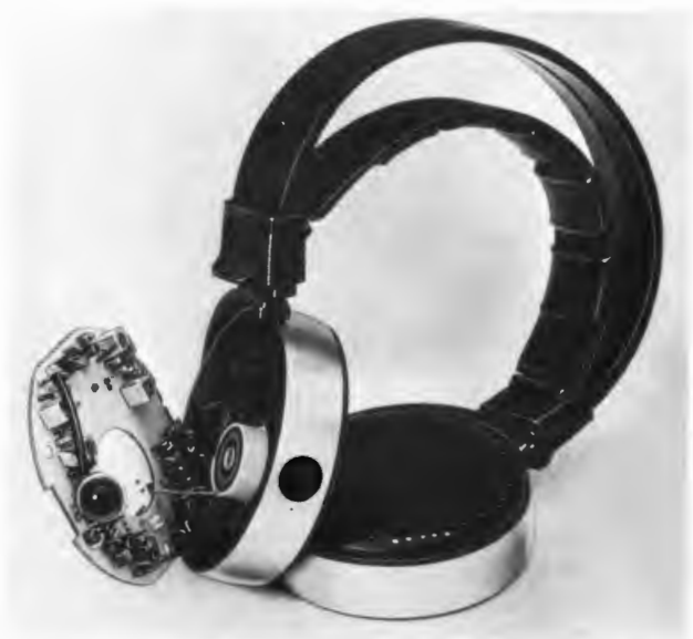
Fig. 12g Cuffia stereo infrarossa (Sennheiser HDI 434); l'auricolare di sinistra è aperto per mostrare il circuito del ricevitore IR
