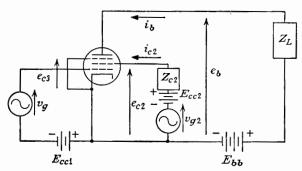
Fig. 6-23. A pentode circuit.
