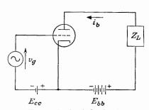
Fig. 6-18. A triode circuit.
