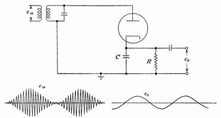
Fig. 5-7. A diode detector.
