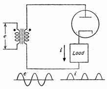
Fig. 5-5. A half-wave rectifier.
