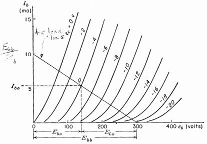
Fig. 6-2. Plate diagram for a triode.
