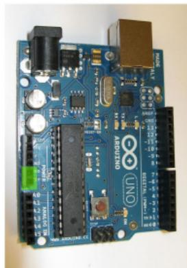
In questo caso dobbiamo collegare una tensione compresa tra i 6.5 V e i 12 V (il polo positivo va collegato sul  $V_{in}$  e il polo negativo sul  $GND$ ). Tale tensione passa attraverso il regolatore di tensione **ma in questo caso non passa per il diodo di protezione quindi bisogna fare attenzione a non invertire le polarità per non bruciare la scheda!!!**
