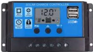
Il regolatore di carica solare (o controller) è un dispositivo posizionato tra i pannelli solari e la batteria che serve a regolare la tensione e la corrente dei moduli solari oltre che per mantenere la corretta tensione di carica sulle batterie.
