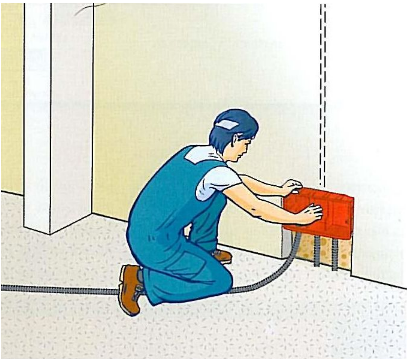
4. Raccordo tra cassetta di arrivo telefono nell'appartamento e box di piana
