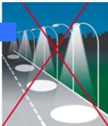
Spegnimento alternato lampade (Impianti tuttanotte-mezzanotte) One on, one off
