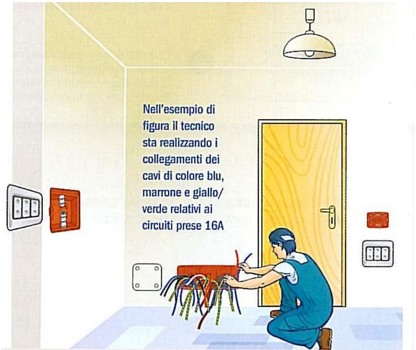
4. Operazione iniziale per effettuare il collegamento della cassetta di derivazione
