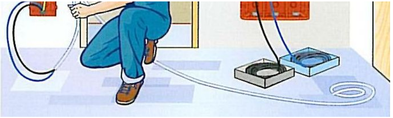
3 Nel caso di circuito separato bisogna infilare una specifica linea
