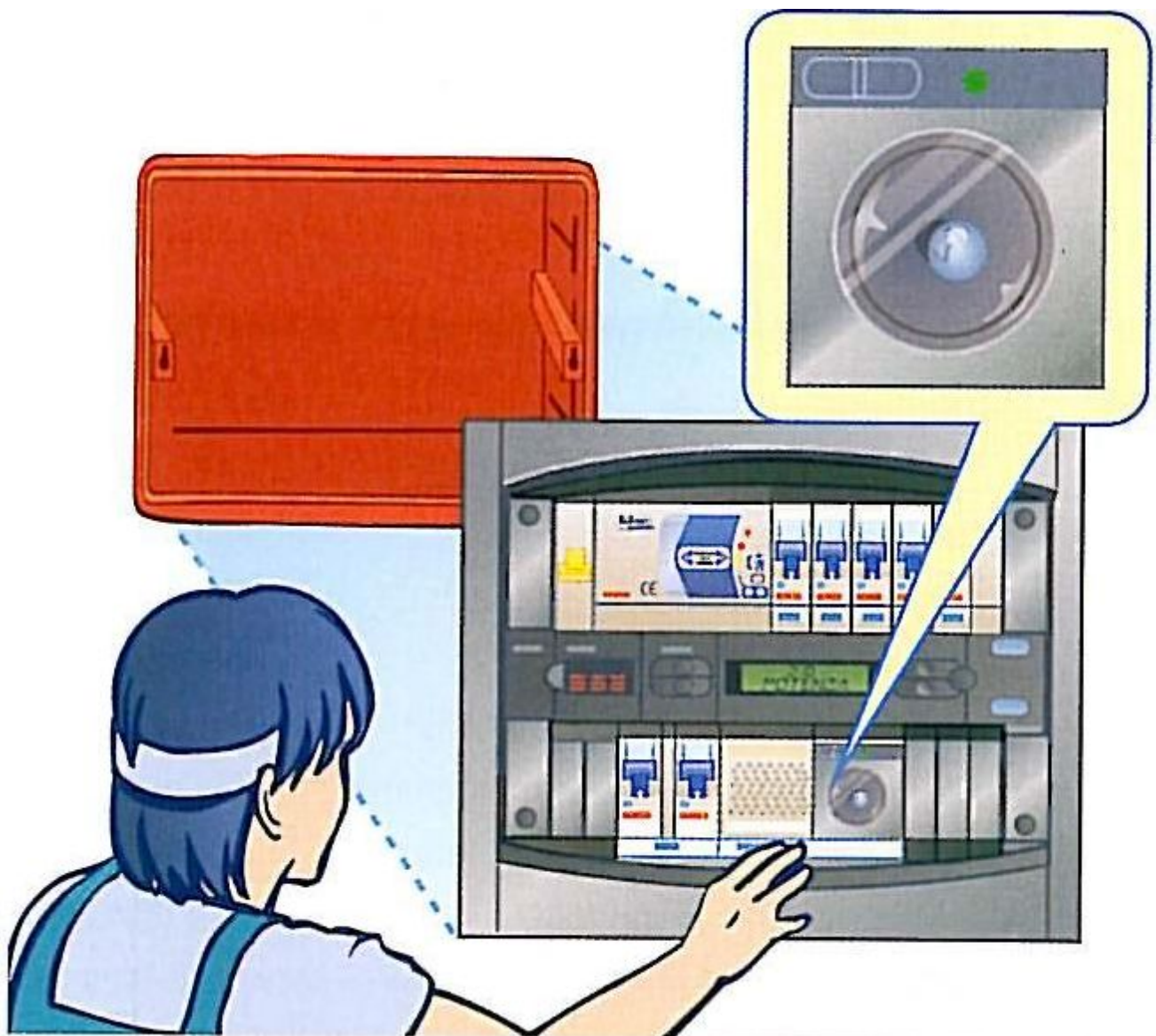
4. La lampada di emergenza è essenziale nel centralino per riarmare gli interruttori automatici dopo un intervento
