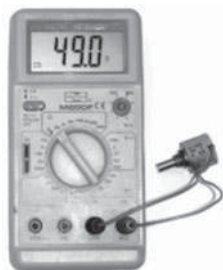
FIGURA 34 Misurando la resistenza del potenziometro si deduce l'impedenza caratteristica della linea.
