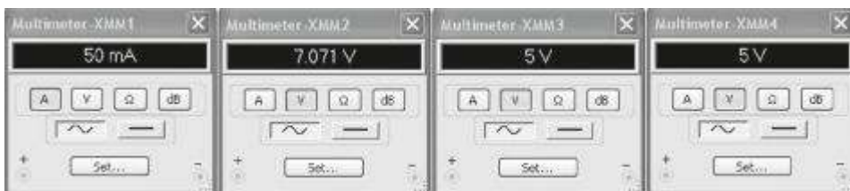
Figura A5.4 Valori efficaci indicati dai multimetri: corrente (XMM1), tensione totale (XMM2), tensione sul resistore (XMM3), tensione sul condensatore (XMM4).
