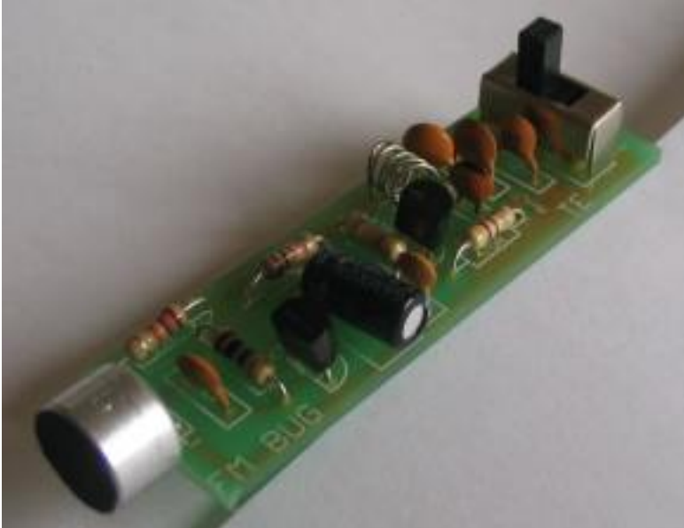
FM TRANSMITTER - 88MHz - 108MHz
