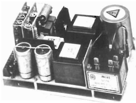
Fig. 15a - Esempio di alimentatore stabilizzato a commutazione. Tensione d'ingresso: 170... 264 Veff. Tensione di uscita: 5 V \pm 3%. Corrente d'uscita: 2... 10 A. Resistenza interna: 4 m \Omega . Particolarmente studiato per apparecchiature digitali.
