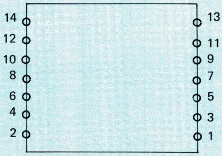
brochage du transformateur
