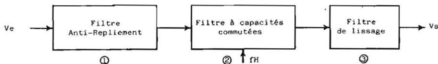
Fig. 4. — Schéma synoptique général d'un filtre à capacités commutées.
